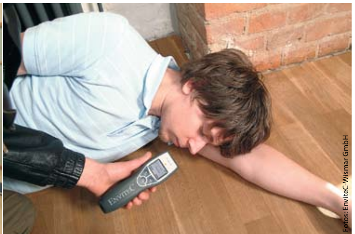
Links: Einsatz des AlcoMed 6040, rechts: Probenahme bei einem bewusstlosen Probanden mit dem AlcoQuant-6020-Testgerät
